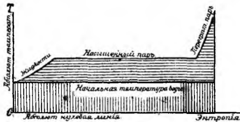
Фиг. 55. Энтропійная діаграмма температуръ водяного пара, теоретическая наибольшая работа.
